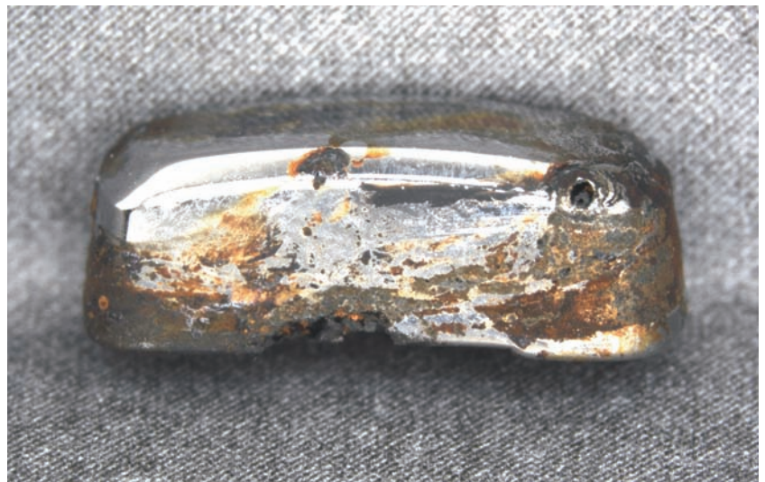
Fig. 1. Exemple d'un poussoir de montre corrodé au brouillard salin dû à une erreur de choix de matière.
