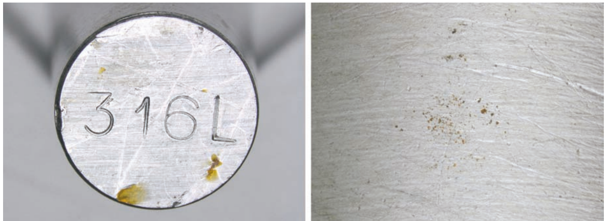
Fig. 2. Exemple de corrosion inattendue sur le bout (à gauche) et le flanc (à droite) d'un échantillon d'acier inoxydable de type 316L; échantillon non passivé, test au brouillard salin.
